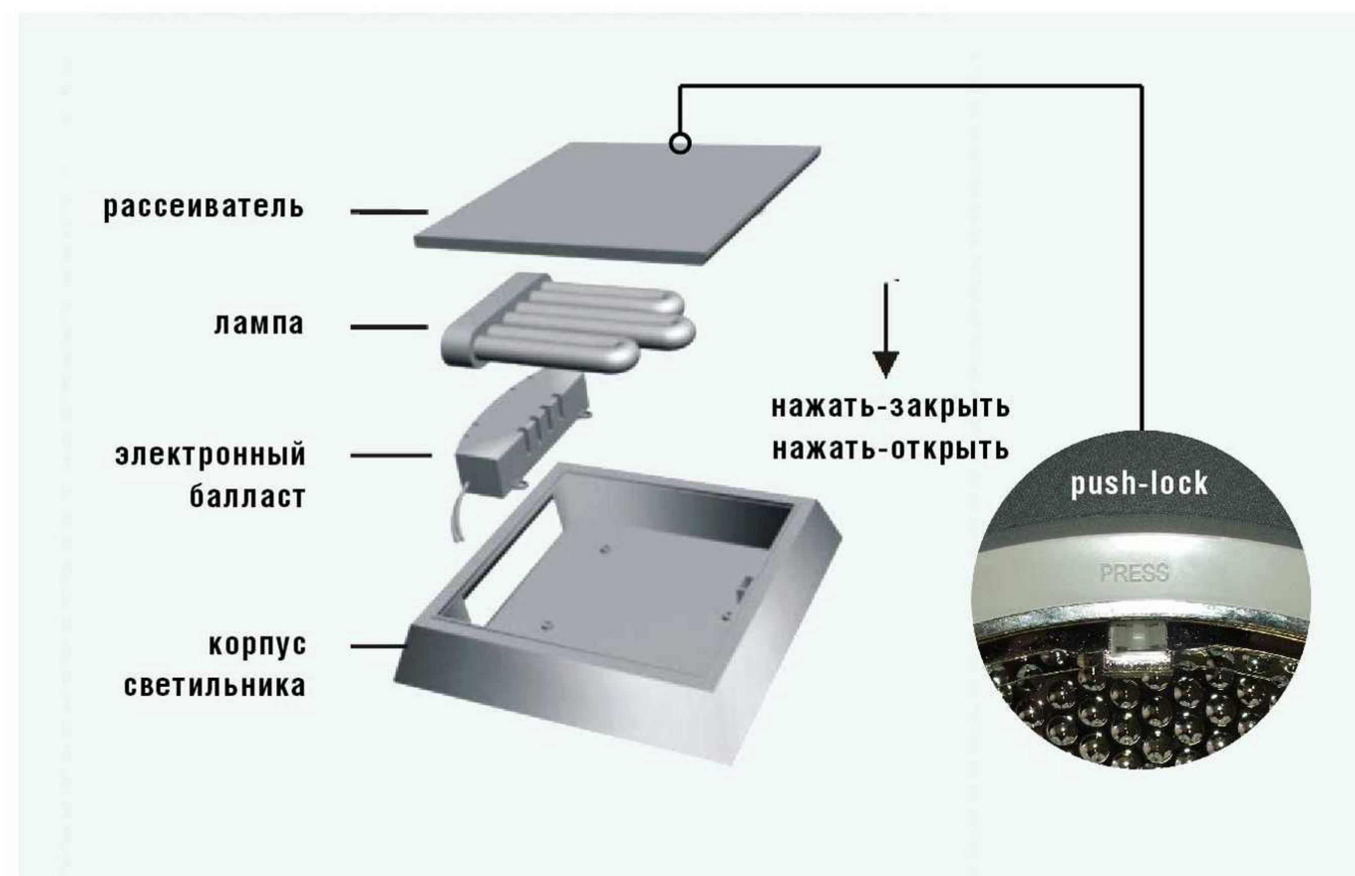
Схема устройства люминесцентных светильников серии N
